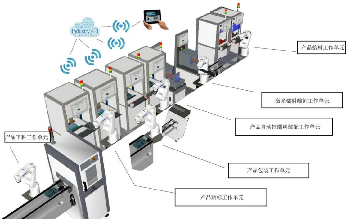
图 1 基于可穿戴产品的工业机器人智能生产线
